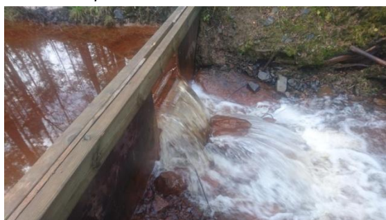
Kuva 2. Leppisuonojan tutkimuspatu. Ojaa on padotettu 0,5 metriä. Tutkimuksella seurataan, vaikuttaako padotus raudan kulkeutumiseen.
